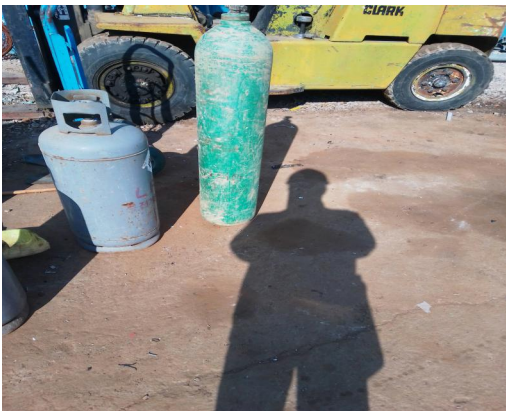
▲ 고압가스용기 보관 불량으로 부딪힘, 넘어짐 위험
