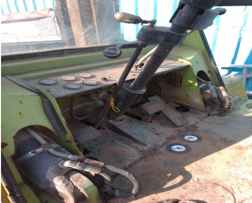
▲ 미운행 지게차 시동키 분리 미시행으로 임의 운행시 충돌 위험
