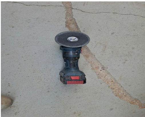
▲ 핸드그라인더 안전커버 미장착
