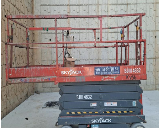
▲ 이동식 고소작업대(시저형)과 상승방지장치 미설치
