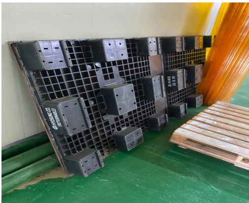
▲ 팔레트 보관 불량으로 부딪힘, 넘어짐 위험
