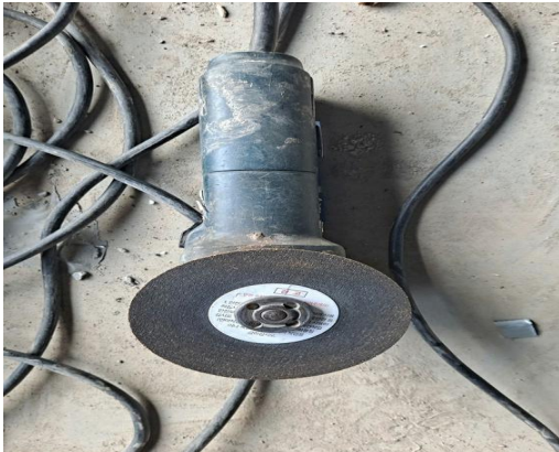
▲ 핸드 그라인더 안전 커버 미장착
